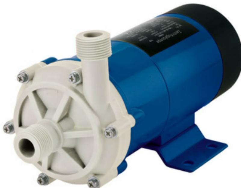
Химические центробежные насосы с магнитной муфтой Lutz TMB разработаны для перекачивания невязких агрессивных сред плотностью до  $1,1 \text{ кг/дм}^3$  и вязкостью до  $20 \text{ мПа}\cdot\text{с}$ , таких как кислоты, щелочей, растворителей, щелочных растворов для обезжиривания, электролитических ванн, фотохимикатов с низким содержанием твердых включений. Эти насосы разработаны специально для установки в небольших системах.
